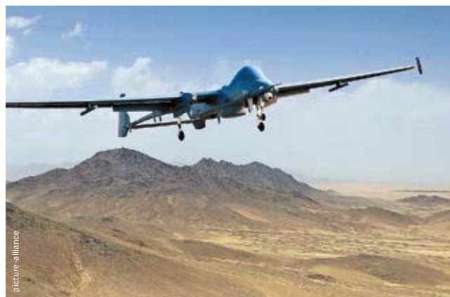
Solche Aufklärungsdrohnen, hier der israelische Typ Heron 1, setzen Bundeswehrsoldaten bereits seit Jahren ein.
